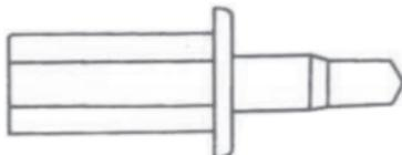
Finalmente coloque o outro pivot superior (peça 4) na extremidade da outra folha da porta, encaixando-o no cursor móvel (peça 2) que desliza no trilho.
