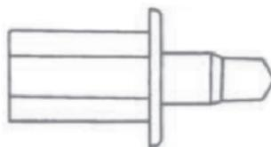
Deve ser instalada na parte superior da porta e encaixado no furo da peça 3.
