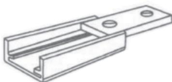
Encaixe-o na extremidade do trilho com o parafuso voltado para a parte interna. Fixe então o trilho no rebaixo do batente e aperte o parafuso do suporte de forma a que o furo fique a aproximadamente 2,4cm da extremidade do trilho.
